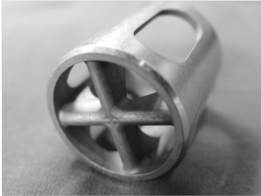
司太立[Stellite]是一种能耐各种类型磨损和腐蚀以及高温氧化的硬质合金。即通常所说的钴基合金，司太立合金由美国人Elwood Haynes于1907年发明。司太立合金是以钴作为主要成分，含有相当数量的镍、铬、钨和少量的钼、铌、钽、钛、镧等合金元素，偶而也还含有铁的一类合金。根据合金中成分不同，它们可以制成焊丝，粉末用于硬面堆焊，热喷涂、喷焊等工艺，也可以制成铸锻件和粉末冶金件。合金粉末适用工艺包括等离子堆焊、等离子喷涂、氧-乙炔喷焊、高频重熔、超音速喷涂及粉末冶金等。
